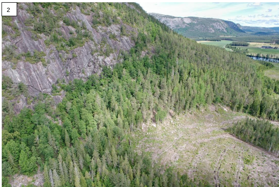
Figur 15. Bildet viser nordlig del av skråningen i nordvest, fra ca. punkt 2 i registreringskartet og nordover. Langs skogkanten ses utløpet av flere rasblokker. Det ligger steinurer «gjemt» i skogen mellom skråningsfoten og flaten. Det finnes også deler der det ikke er ur.
